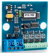
NOX IO4 Standard Ein-/Ausgangsmodul zum Anschluss konventioneller Melder (vier Ein- und Ausgänge).
